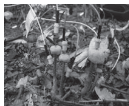
図1：オオキツネタケのキノコに設置された電極
