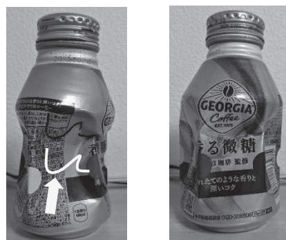
図 2：側面上部を潰した缶の爆縮後(矢印は潰した場所を指す)
