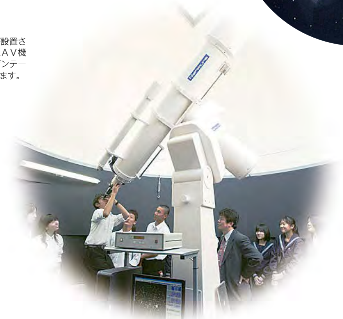
⑪天文ドーム [1号館屋上] (西村製作所) 直径4.5mの電動式ドームに、コンピュータ制御の口径25cm屈折望遠鏡を設置。天体観望会が定期的に開かれます。
